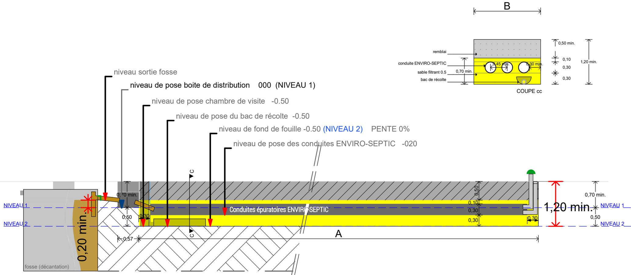
Couverture de 60 cm au dessus des conduites min.
